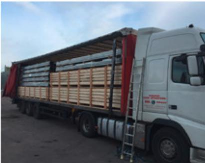
Bei RiModul® flat werden die Profile nach der Bearbeitung nummeriert und in Einzelteilen angeliefert. Mit Hilfe eines Montageplans lassen sie sich auf der Baustelle oder in einem Zwischenlager einfach zusammenbauen. Die Profile werden pro Wand- oder Deckenelement gebündelt angeliefert.
